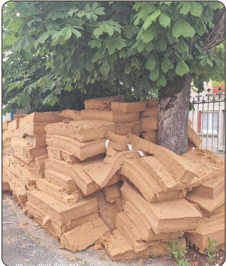
Laine de bois gorgée d'eau, destinée à la dechetterie
